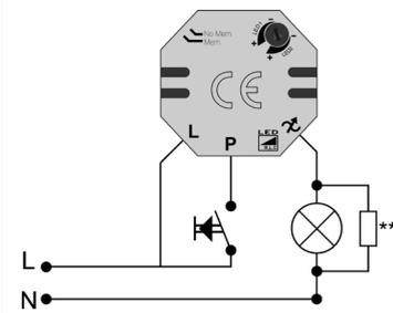
\*\*Hinweis: Wenn nach dem Ausschaltbefehl die Lampe nicht vollständig erlischt, muss das Grundelement (im Lieferumfang enthalten) parallel zur Lampe installiert werden.
