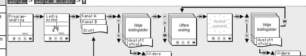
I menyen Program endring har du muligheten til å endre programmerte koblingstider per kanal.
